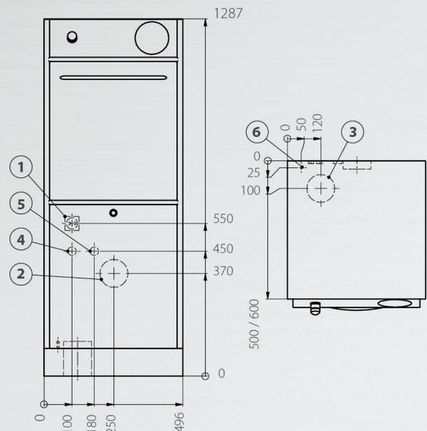
**1** Steckdose 230V, 50Hz, 16A **2** Wandabfluss DN100 Standard (entfällt bei Bodenabfluss) **3** Bodenabfluss DN100 Alternativ (entfällt bei Wandabfluss) **4** Anschluss Wasser (warm), Wandanschluss 1/2" mit 3/4" Außengewinde **5** Anschluss Wasser (kalt), Wandanschluss 1/2" mit 3/4" Außengewinde **6** Potentialausgleich
