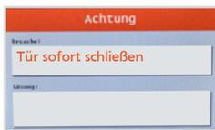
**Ursache:** Tankfüllung höher als Sollwert (Einlassventil defekt) oder automatische 24h Desinfektion steht an
