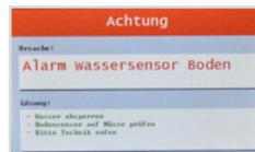
**Ursache:** Undichter Tank oder Siphon, Wasser vor Maschine verschüttet
