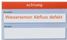
**Ursache:** Kabelbruch zum Wassersensor im Siphon
